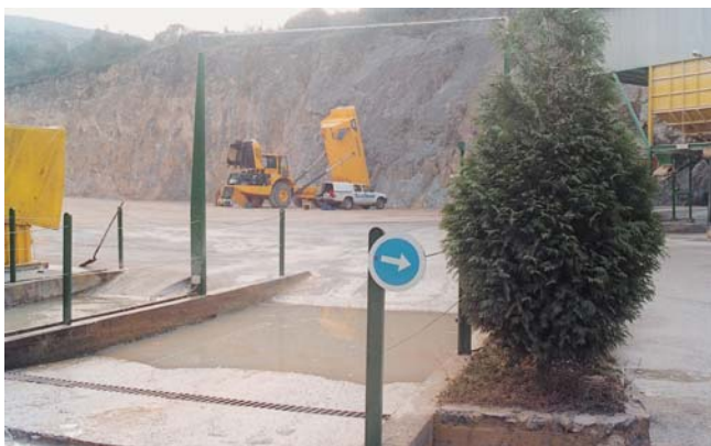
Piscina para el lavado de ruedas de camiones a la salida de la planta de tratamiento
