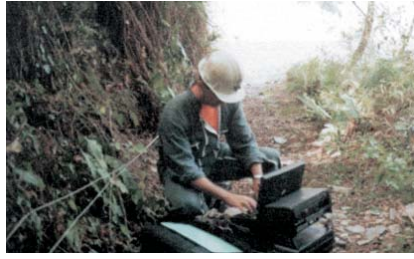
Medición de las vibraciones
