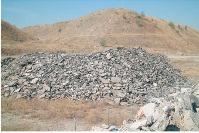
Residuos de hormigón preparados para su reciclado
