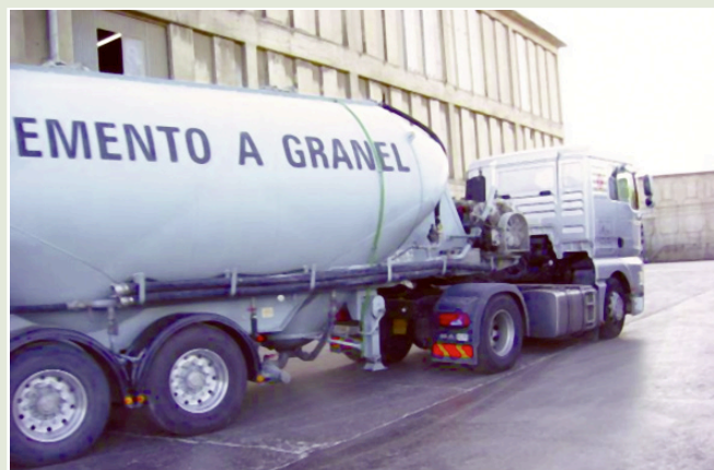
Camión cisterna para transporte de cemento a granel
