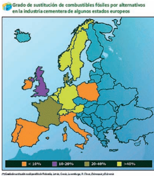
Figura 1.3. Grado de sustitución de combustibles fósiles por combustibles alternativos en la industria cementera de algunos países europeos, año 2008. (Fuente: Oficemen).
