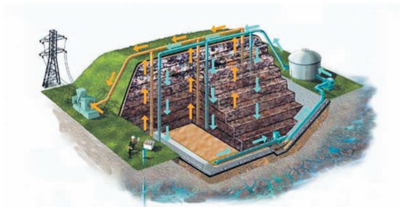
Figura 2.5. Esquema de un Biorreactor Activable en celdas de vertedero.
