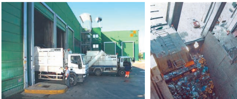
Foto 2.2. Descarga de residuos y foso de recepción. (Fuente: ECODECO y L. Martínez Centeno).
