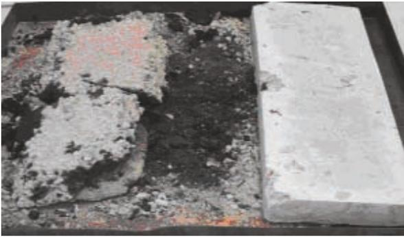
Fig. 12 - Probeta de mezcla bituminosa (izqda.) y hormigón (dcha.) tras un ensayo de ignición (Universidad de Cergy-Pontoise)
