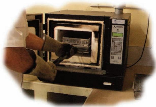
Dicho método de determinación del contenido de ligante por ignición ha sido recogido en la norma ASTM D6307 [15] y posteriormente en la norma UNE-EN 12697-39 [16].
