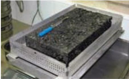
(a) Probeta de mezcla bituminosa antes de ser ensayada
