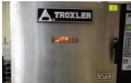
(d) Ignición de la mezcla bituminosa durante el ensayo
