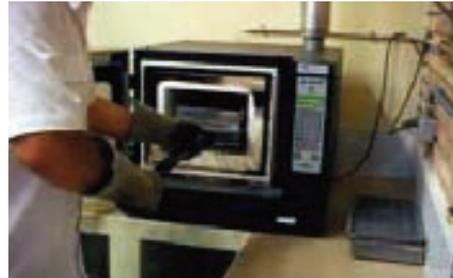
(b) Introducción de la probeta en el horno
