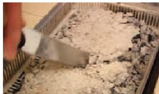
(f) Después del ensayo la mezcla bituminosa pierde por completo su cohesión, siendo fácilmente disgregable
