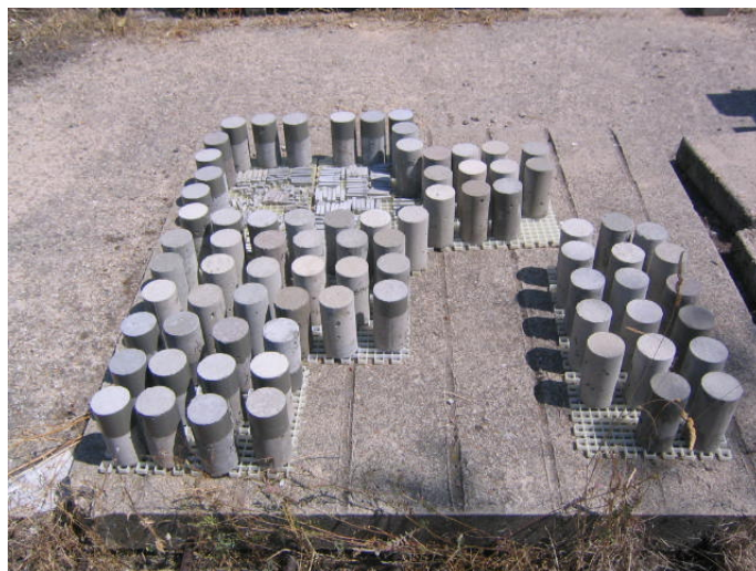
Figura 3. Probetas de hormigón fabricadas de dimensiones 75mm x 150mm.
