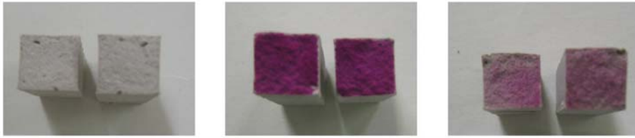
Figura 9. Tonalidades de la fenolftaleína. a) incolora: \text{pH} < 8 . b) rojo púrpura intenso: \text{pH} > 9,5 . c) rosa suave: 8 < \text{pH} < 9,5 .
