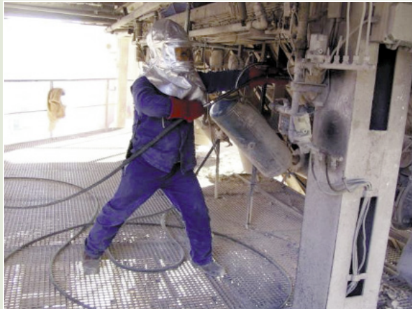
Figura 16. 6. Limpieza tradicional con aire - agua
