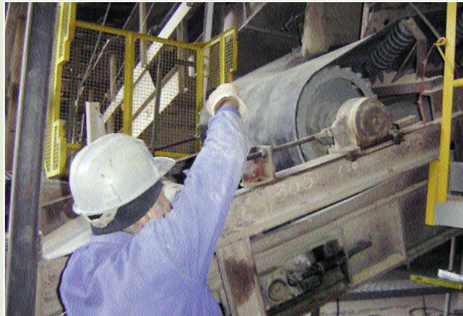
Figura 22. 6. Mantenimiento de cinta transportadora
